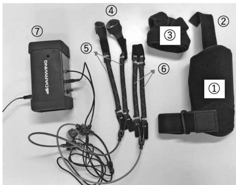
図 2. 人工筋型牽引スピントの必要パーツ
