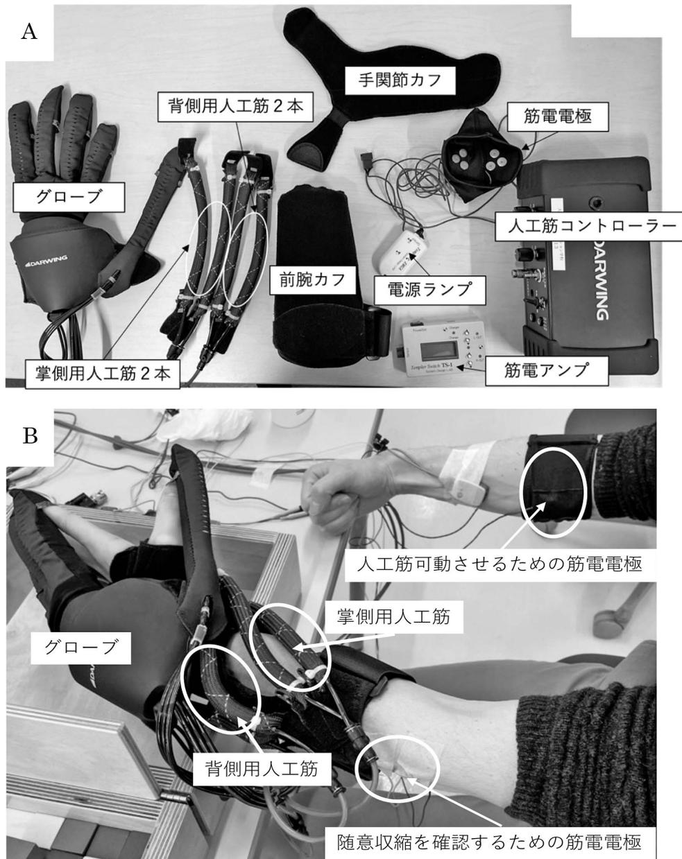
図1. 人工筋型筋電スプリントの必要パーツと装着図
