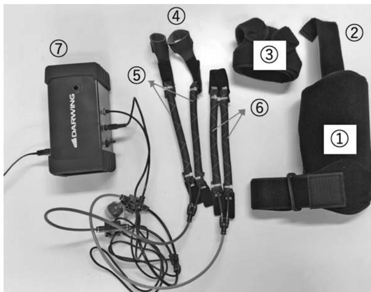
図 2. 人工筋型牽引スプリントの必要パーツ
